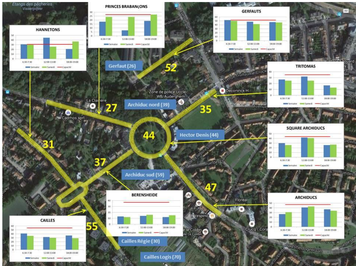
Fig. 6. Occupation du stationnement par tronçon (semaine = moyennes sur 4 jours ; samedi = moyennes sur 2 jours). La ligne rouge représente la limite de capacité, les colonnes bleues sont les valeurs en semaine, les colonnes vertes les valeurs du samedi. Données détaillées par tronçons en annexe 2.
