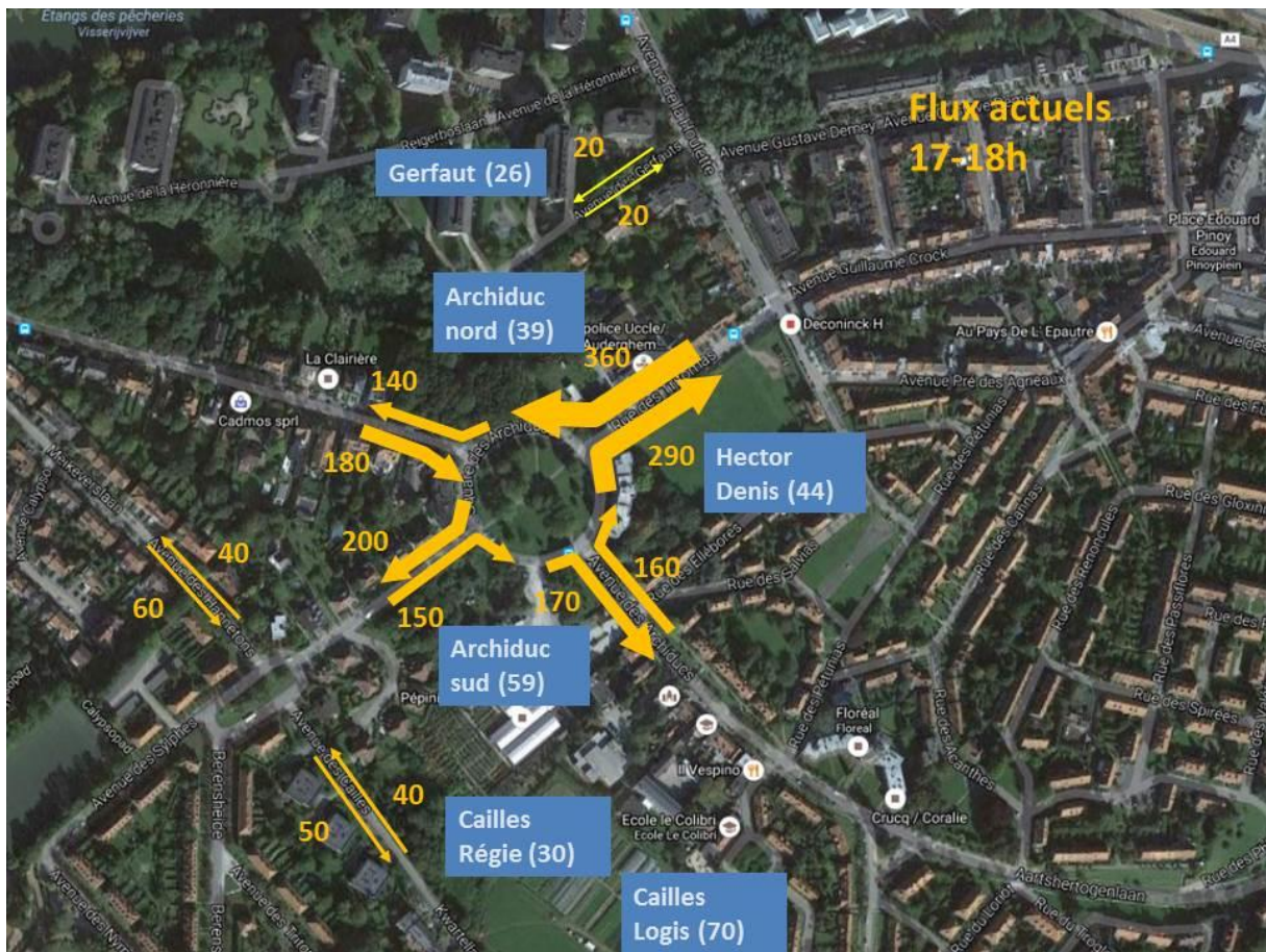
Fig. 2. Flux de trafic actuels à l'heure de pointe du soir en semaine (evp/h)
